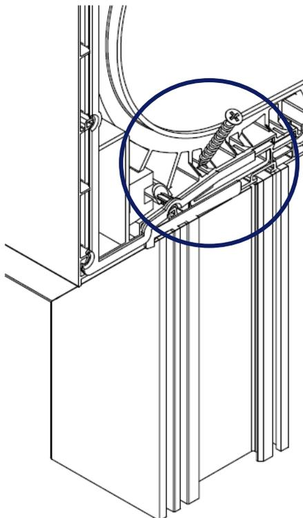
④ Fixer l'extrémité du coffre sur la menuiserie à l'aide d'une vis 4.2 x 40mm.
